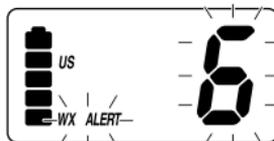
**4** Para apagar la alerta meteorológica, oprima y mantenga **WX/ALERT** por 1.5 segundos. Un tono doble de confirmación sonará.
