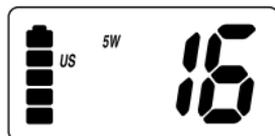
Cuando la pila esté casi descargada, el indicador de la pila aparecerá como se muestra:
