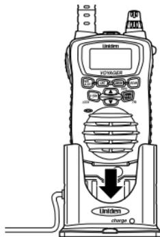
**2** El LED rojo se ilumina y se mantiene encendido.
