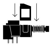
$\square$  18. Install the DPDT mini power switch at SW1
