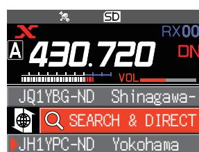
接続先表示(画面の下段)の先頭に“▶”が表示されているときに、DIAL ツマミまわして接続先表示に自局が以前に接続したインターネット上のノードまたはルームを点滅表示させます。
