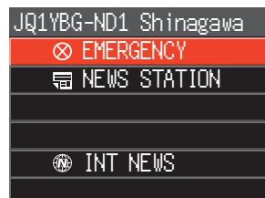
3. PTT スイッチを押すと、ビープ音が鳴って “EMERGENCY Upload?” と確認画面が表示されます。緊急の情報を送る場合は、そのまま PTT スイッチを押し続けると、ビープ音が 3 回鳴った後に約 5 秒間 “EMERGENCY UPLOADING” が表示され、その後カウントダウンが開始します。マイクに向かってメッセージを話します。録音可能な時間は、最大 1 分間です。1 分を越えた部分の音声は保存されません。
